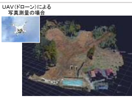
写真データから3次元地形データを作成
