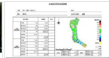
3次元設計データと3次元出来形測量の結果を重ね面的な管理を行う
