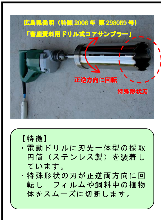
図 1 試作した「コアサンプラー」
