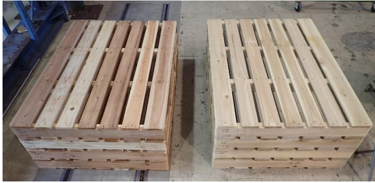
図1 作製した平パレット (左:スギ, 右:コウヨウザン)
