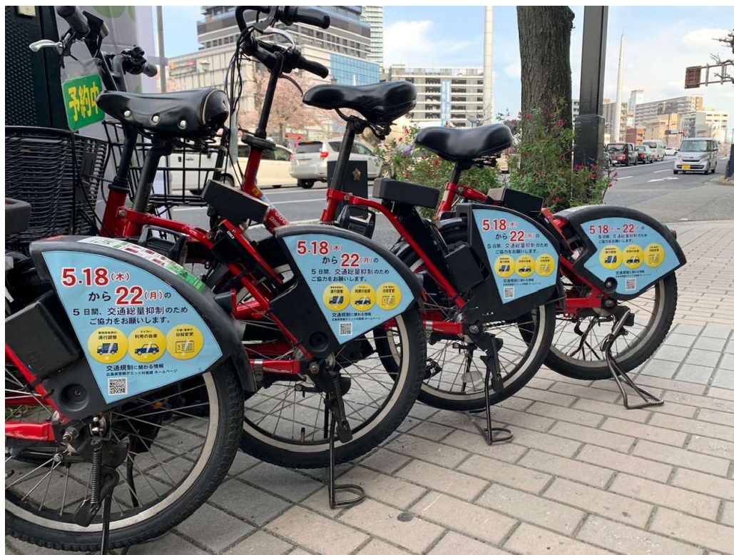
ドレスガード左側面（縦173mm×横180mm）
