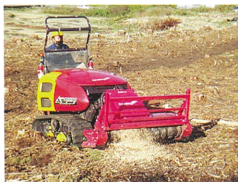
写真3 林業機械の走行経路最適化 （切株破砕実証試験）
