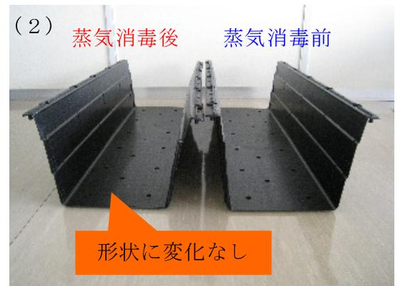
写真1 試作品 (農業用資材) の蒸気消毒前後の形状
