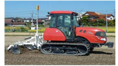
レーザーレベラーを装着したトラクターによる緩傾斜施工
