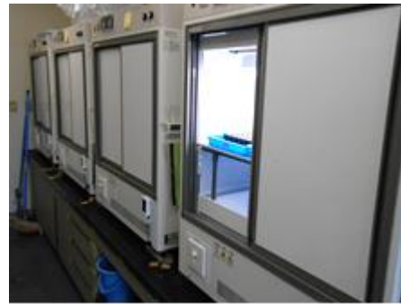
図1 インキュベータを用いた育苗実験の様子
