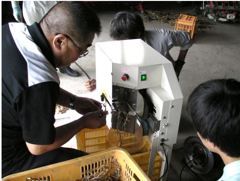
ワケギ球根調製機による調製作業
