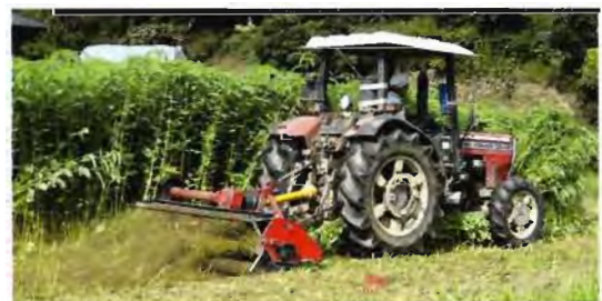
図2 フレールモアによるセスバニアの裁断
