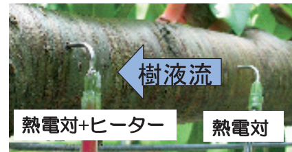
図1 モモ樹の主枝に挿入した樹液流速センサー
