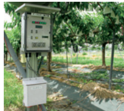
図2 モモ園に設置した樹液流速計測システム試作機本体
