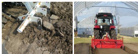
図 1 プラソイラ(左)と逆回転ロータリー(右)
