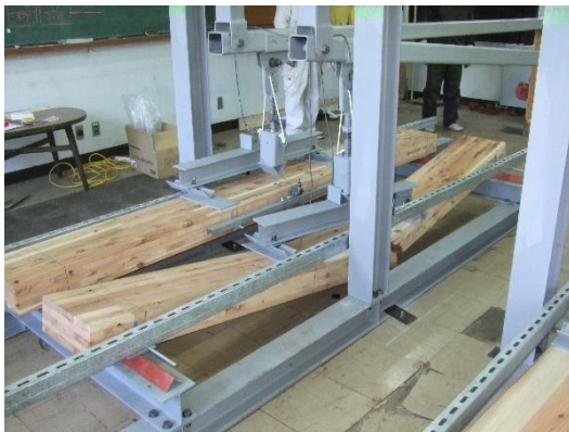
写真2 試験で破壊したCLT
