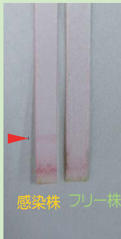
乾燥させる ウイルスに感染している場合は赤い微粒子がろ紙上で帯となって見えます
