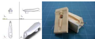
3次元形状計測, 3次元CADによる型設計 ラピッドプロトタイピングによる試作
