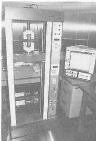
恒温恒湿器内の万能引張圧縮試験機
