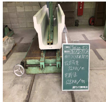
曲げひび割れ耐力試験
