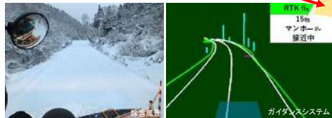
タブレットに障害物等を表示し、接近時にアラートを行う
