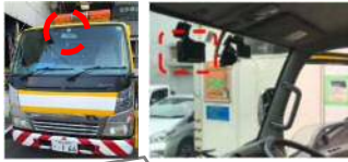
ドライブレコーダーで取得した画像をAI画像解析することで路面性状を把握する技術を構築（R4.10～）
