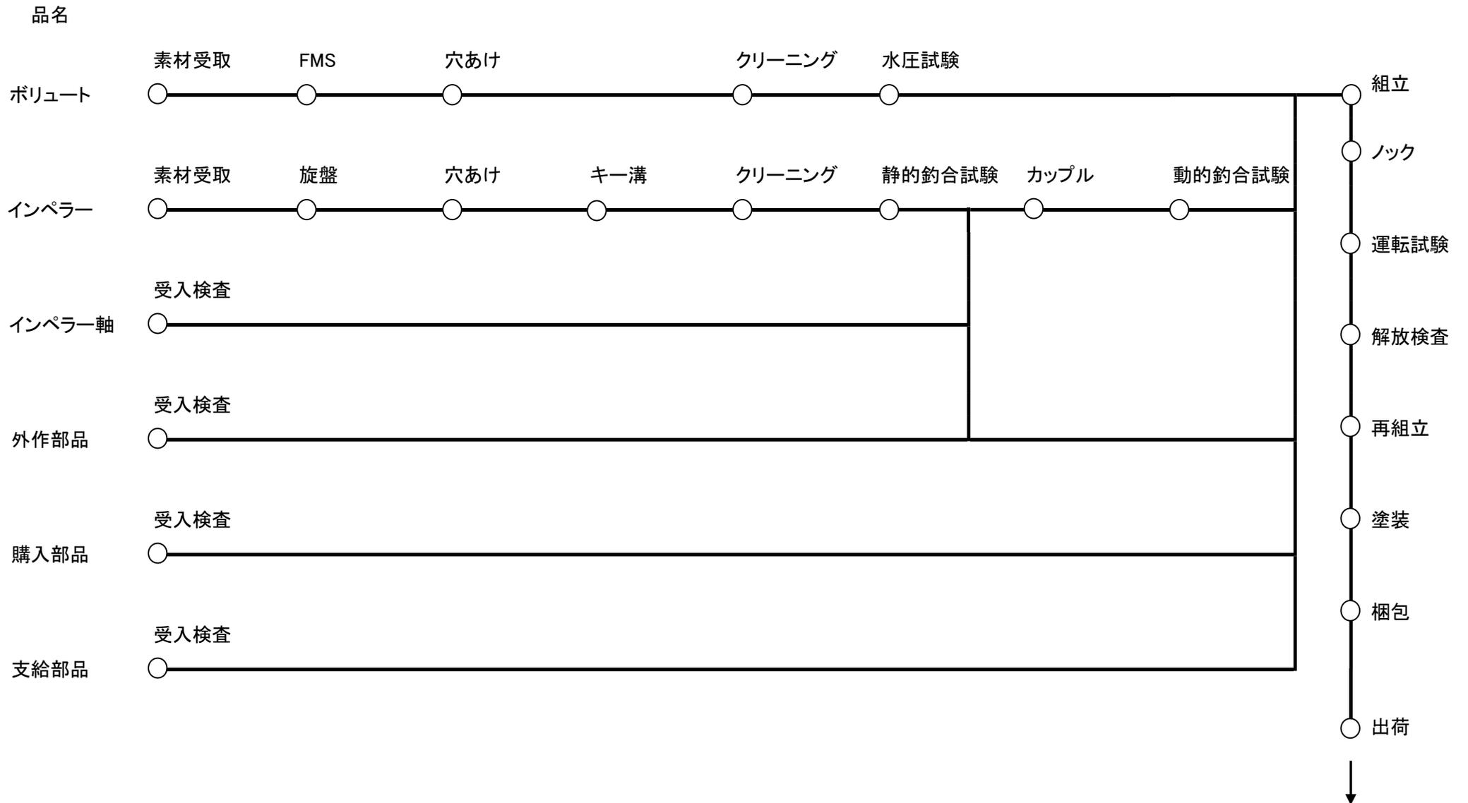
(図2) 鑄造製造工程
