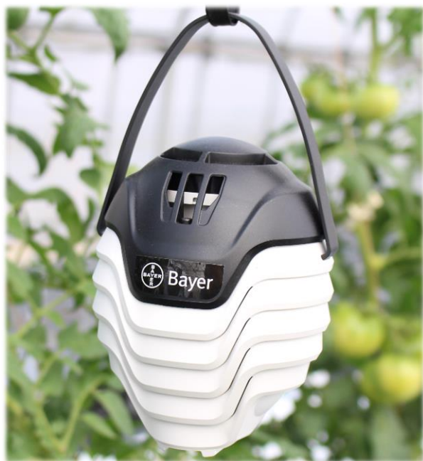
「プランテクト®」の環境データ取得用センサー
