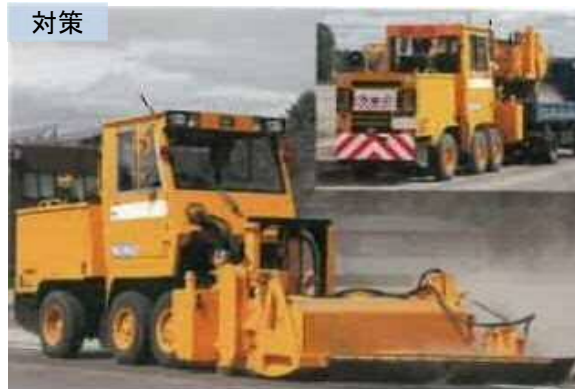
定期的な路面清掃のための機械の導入
