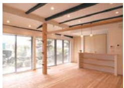
縁側を内包して明るさを確保している。既存の鴨居の面影を持たせたキャットウォークが部屋を横断する。
