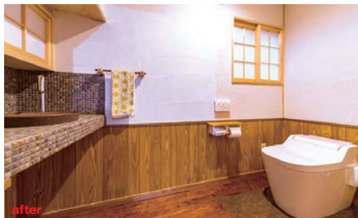
無垢材(クワ)の床の一部にタイルを使用し掃除しやすとした。天井、腰壁は杉、しっくい塗壁と和風にした。
