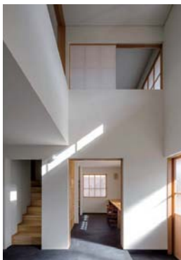
冬は南側より差し込む日射熱を床に蓄熱させ室内環境の安定化を図る。
