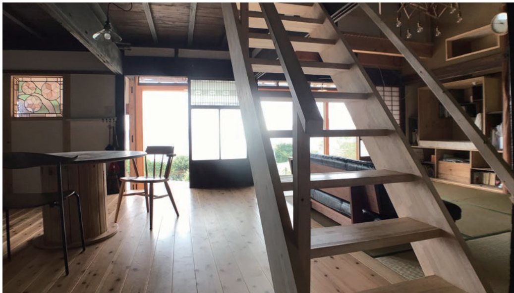
ダイニングは和室とフラットに繋がりつつ、床仕上げや天井高さの違いでやんわりと仕切る。
