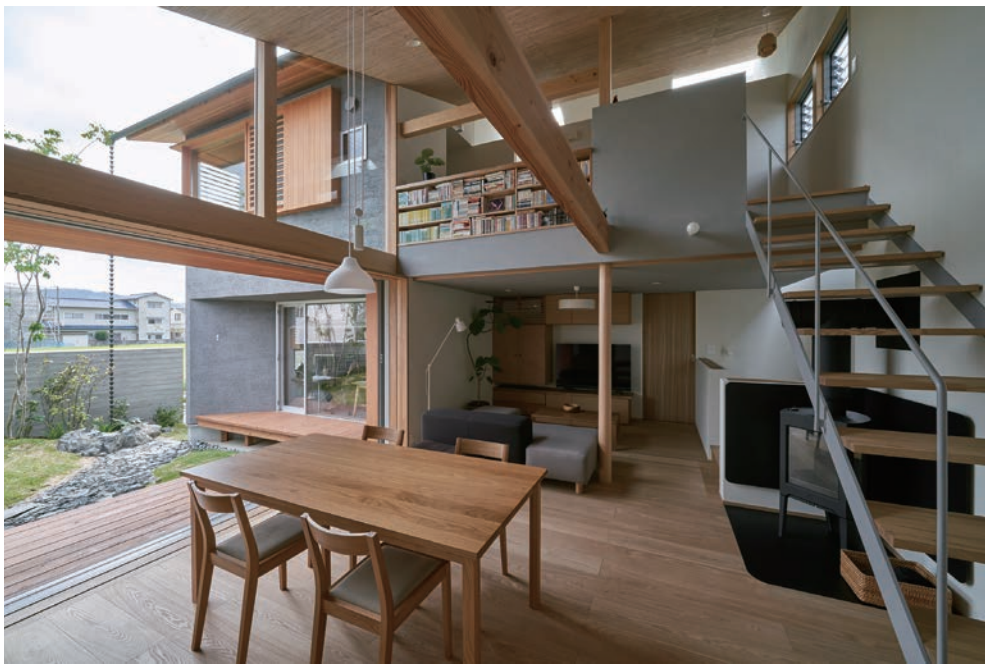
床面積以上の広がりを感じる。壁は微妙な色合を調合した梨地の左官仕上として光をやわらかに拡散させている。
