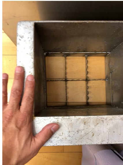
図2 小型底びき網に入ったクラゲ【昨年度の写真】(左) と、クラゲ切断機(右) クラゲを船体に備え付けた切断機で切断して海に返すことで、駆除する。
