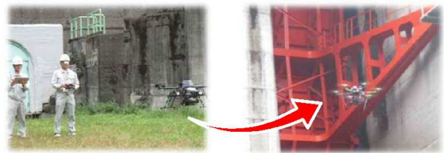
ドローンを活用した施設点検
