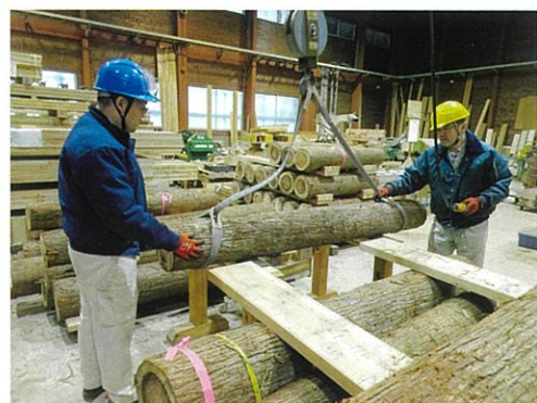
写真3 植栽密度の異なる丸太の計測 (重量および縦振動周波数の測定)
