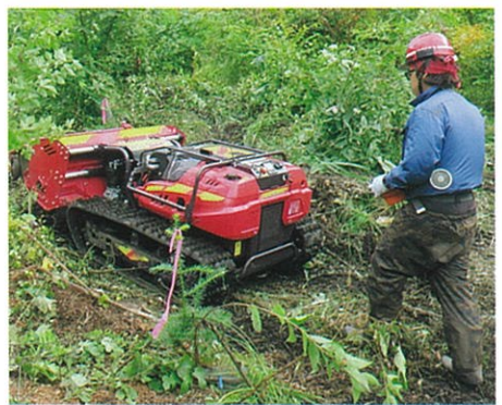
写真2 ラジコン式下刈機械の実証試験 (植栽した苗木を避けながら刈払い)
