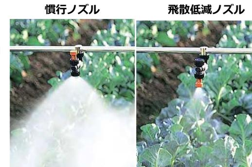
飛散低減ノズルでは、ノズルに空気吸入孔を設け、薬液に空気を混入して粒径を大きくし、散布量が増えないように工夫されているものも多い
