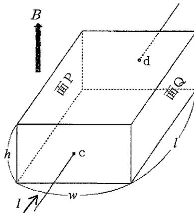
キャリアの移動によって、試料の内部に電場が生じる。この電場による力とローレンツ力が釣り合いの状態になったとき、キャリアは試料の中を直進するようになる。このときの試料中の単位体積当たりのキャリアの数を  $n$  [個/m<sup>3</sup>] とすると、キャリアの速さ  $v$  [m/s] は  $v =$  【イ】 と表され、ホール電圧を  $V$  [V] とすると、 $V =$  【ウ】 と表される。
