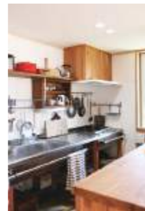
屋根垂木の余りをフレームにした大工さんの手づくりキッチン。アクセントに古材を使用。
