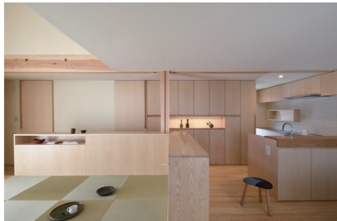
壁面の造作家具の建具と、洗面脱衣室の入口建具の素材・面を揃え、連続させて一体に見せた。
