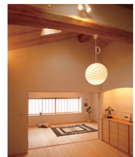
2階の洋室は窓がない暗い部屋だったが、天窗を設けることで光が入り込むつながりの間になった。
