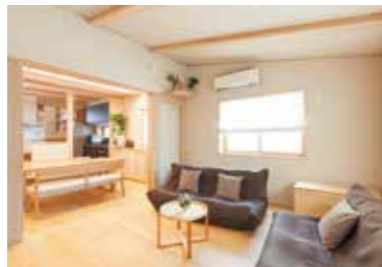
勾配天井のリビングはダイニングとの間に両引き分け戸を設けており、用途に応じて間仕切りが可能となっている。
