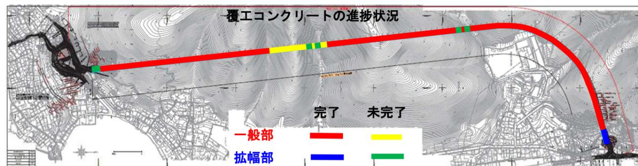
覆工コンクリート（一般部・拡幅部）のイメージ
