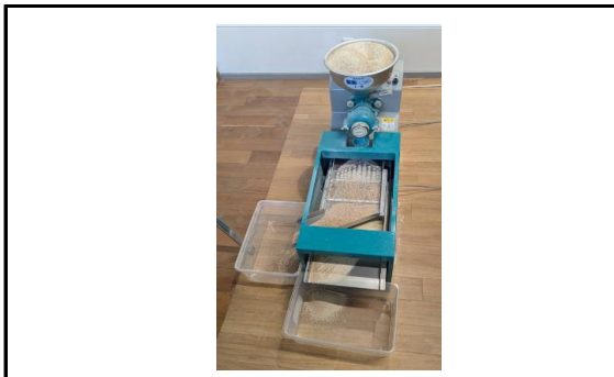
製粉とふるいが一体となった石臼式機械を使って製粉しています。
