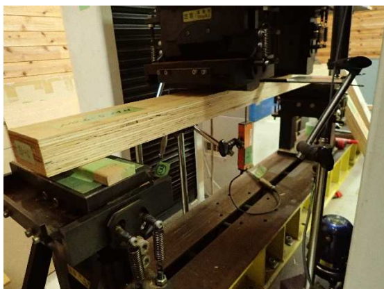
写真1 広島県産コウヨウザン LVL 曲げ試験 写真2 茨城県産コウヨウザン LVL 曲げ試験
