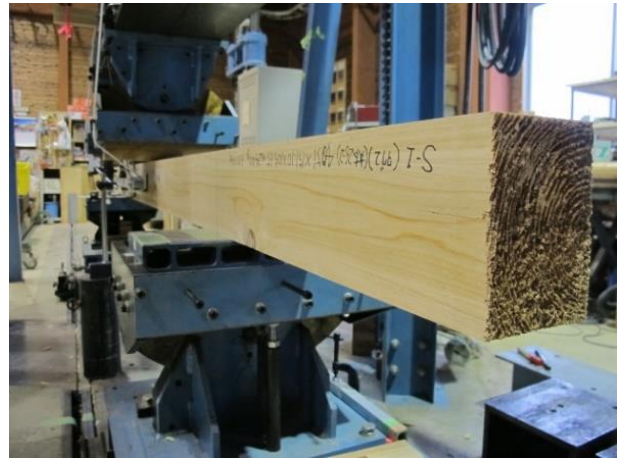
写真2 平角材の曲げ試験
