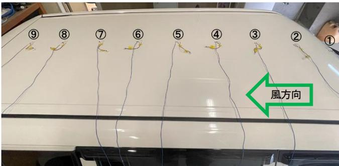
図7 熱流束と温度の測定位置(ルーフ)
