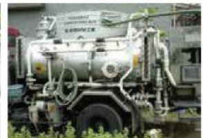
浄化槽汚泥濃縮車
