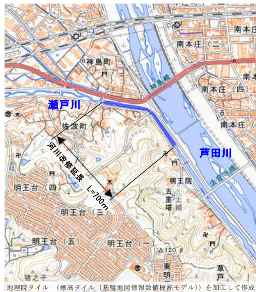
河川改修区間（福山市草戸町）
