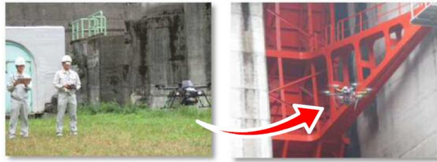
【ドローンを活用した施設点検】
