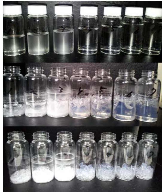
写真1 ゾルゲル溶剤の混合と固化の様子
