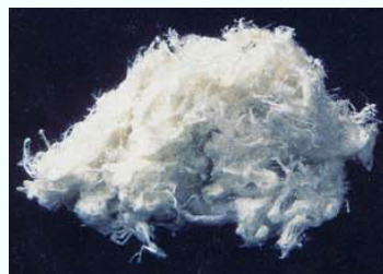
白石綿 (クリソタイル)
