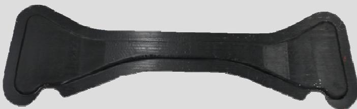
自動車部品「トランスバースメンバー」のCFRP試作品
