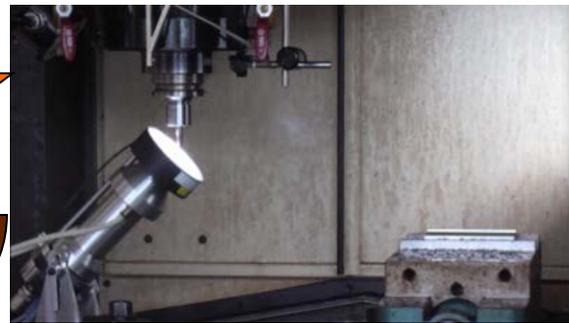
【試作した機上工具観察システム】
