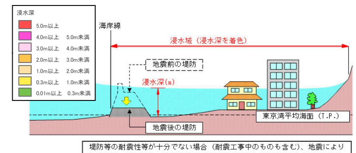
堤防等の耐震性等が十分でない場合（耐震工事中のものも含む）、地震により破壊され、地域によっては津波が襲来する前に浸水が始まることがあります。
