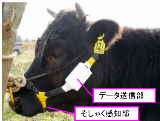
図1 装着したそしゃくセンサー
