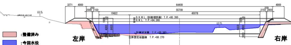
令和3年8月豪雨では平成30年7月豪雨と同等の総雨量459mmを記録したが、当該箇所では左右岸の護岸整備の効果が発揮され、家屋浸水被害を防止した。
