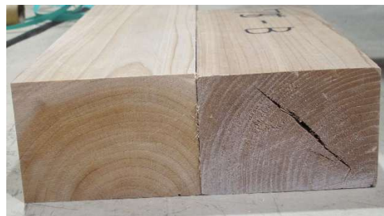
写真-10 平角材の乾燥(左:中温 右:高温)
