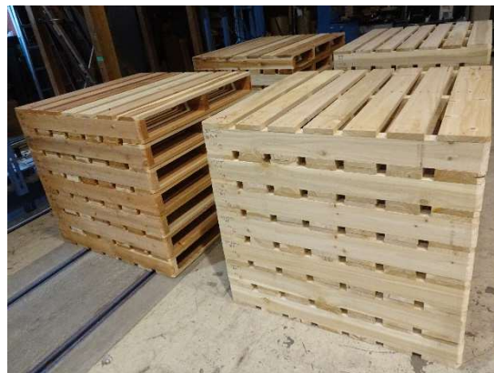
写真-23 作製した平パレット 右:コウヨウザン(手前 T11 型、奥 T14 型) 左:スギ( // )
