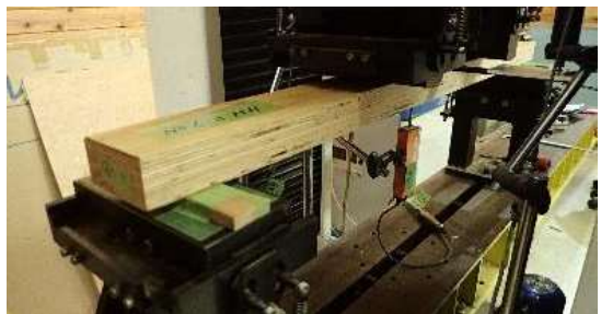
写真-17 LVLの強度試験(フラットワイズ)
