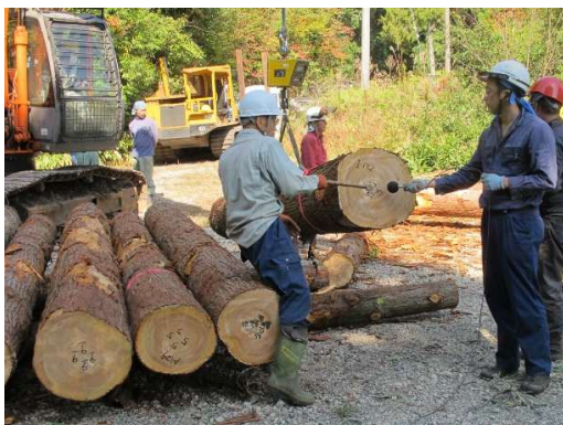
写真-8 原木丸太の計測(縦振動ヤング)
