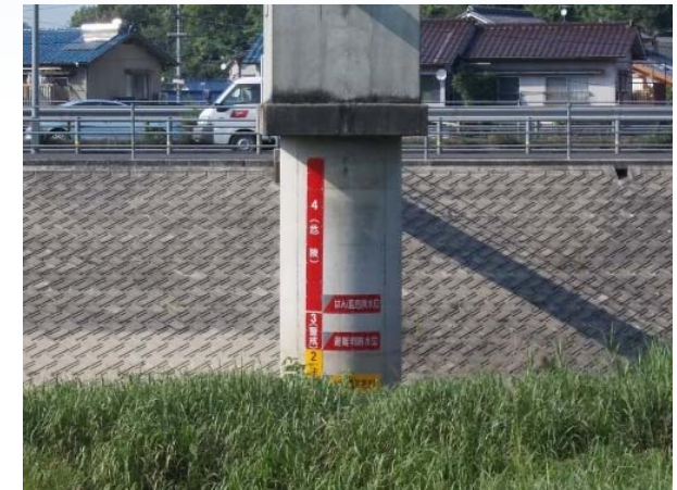
水位計の設置と表示板の例 (瀬戸川: 西神島観測所の状況)
