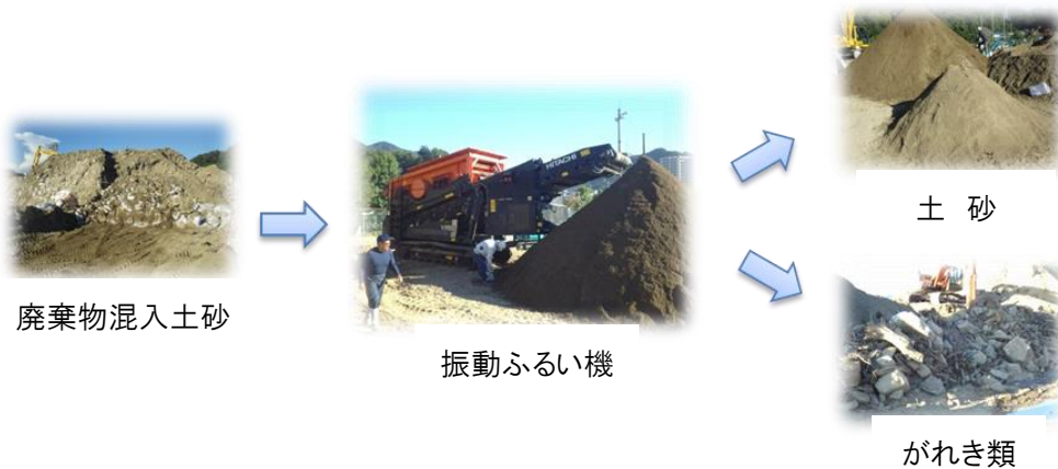
図 4-3 廃棄物混入土砂分別の例
