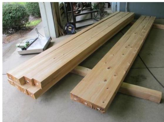
写真5 良好な材質(節の少ない平角材)
