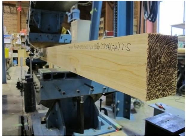
写真2 平角材の曲げ試験
