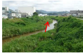
河道掘削時には滞筋の確保を図る
